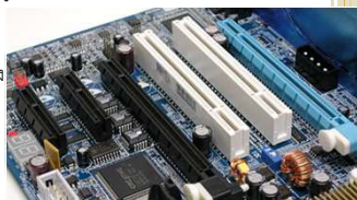
รูป: เป็นสล็อตเพิ่มขยายของ Gigabyte รุ่น GA-G1975X ที่สล็อตเพิ่มขยายสำหรับการกราฟิก (Graphic Card) ได้มากถึง 4 การ์ด และ 2 การ์ดพีซีไอ
