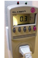
Tweet-a-watt: ตรวจสอบการใช้พลังงาน
